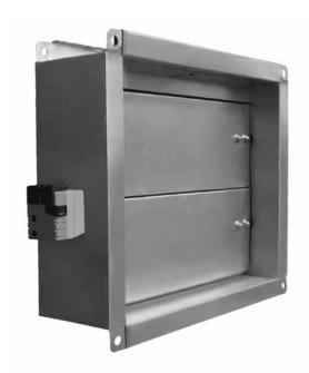
• В зависимости от предъявляемых требований клапан имеет разные варианты комплектации электроприводом. Установленный в системе вентиляции клапан регулирует количество подаваемого воздуха путем поворота лопаток с помощью привода.
